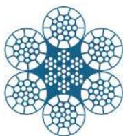
Los cables de arrastre de Dyform tienen una alta resistencia y una periferia suave para reducir la polea y el desgaste de la polea.
