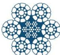
El Dyform seapurse IWRC de Alma de Acero es un cable especialmente diseñado con alambres exteriores de mayor diámetro para aumentar la resistencia a la abrasión y una superficie lisa apta para resistir el paso de las anillas.
