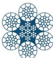
El Dyform RL tiene un núcleo IWRC invertido que proporciona una resistencia adicional a la rotación.
