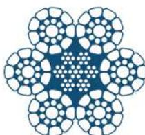
El Dyform seapurse IWRC de Alma de Acero es un cable especialmente diseñado con alambres exteriores de mayor diámetro para aumentar la resistencia a la abrasión y una superficie lisa apta para resistir el paso de las anillas.
